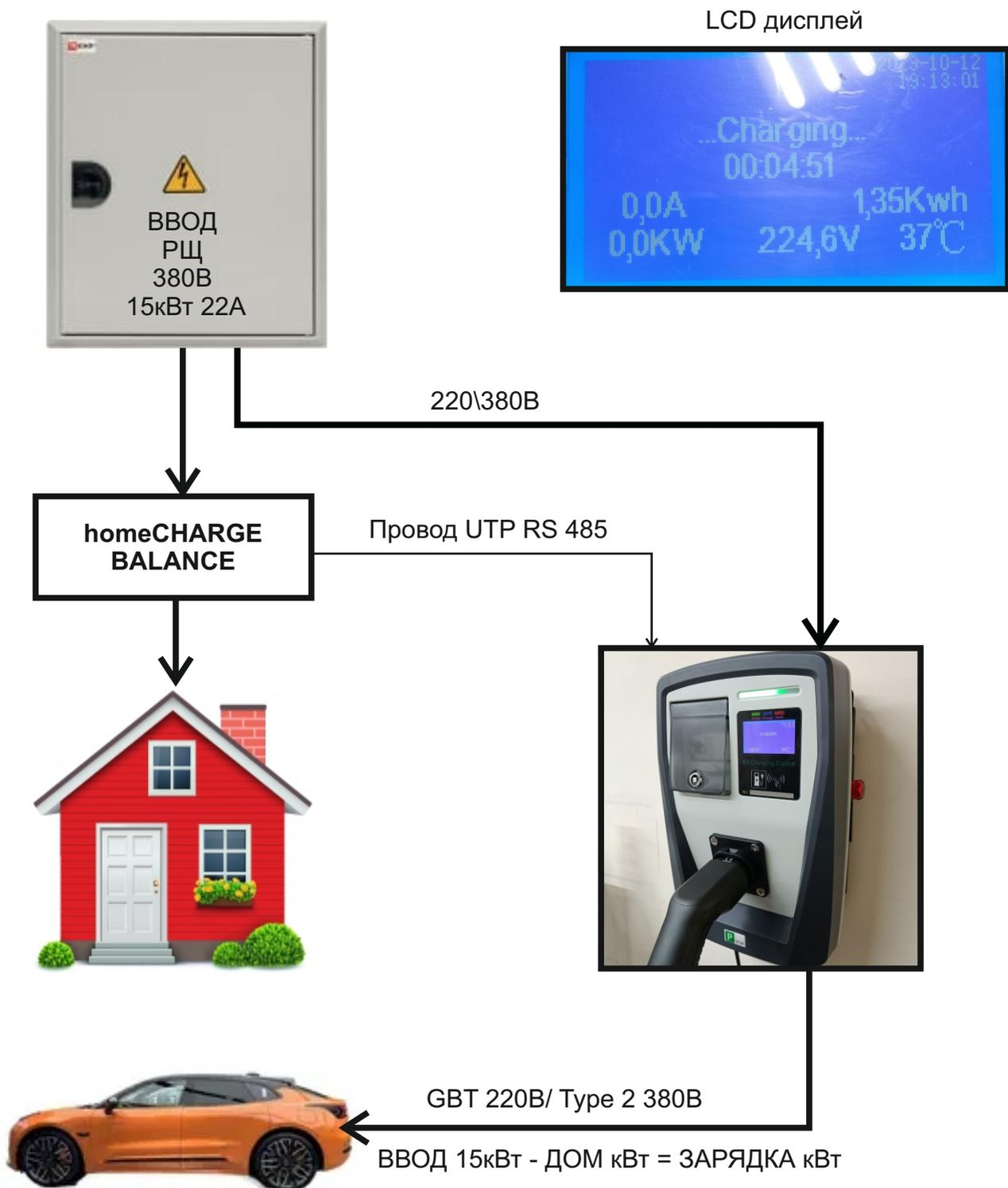
Безопасная и надежная медленная зарядная станция **homeCHARGE 4 balance** подходит для применения в частных домах с ограниченной выделенной мощностью. Для зарядки электромобиля используется мощность, равная разности между выделенной мощностью и мощностью, потребляемой домом.
